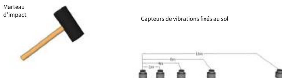
Figure 25. Caractérisation de sol : Méthodologie MASW active
