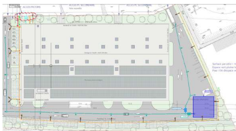
Bassin d'infiltration des eaux pluviales pour le projet CINOV (source : ARTELIA) 52
